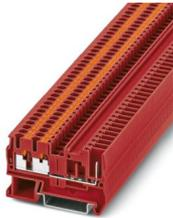
Durchgangsklemme, Nennspannung: 500 V, Nennstrom: 24 A, Anzahl der Anschlüsse: 3, Polzahl: 1, Anschlussart: Push-in- / Steckanschluss, Bemessungsquerschnitt: 2,5 mm<sup>2</sup>, Querschnitt: 0,14 mm<sup>2</sup> - 4 mm<sup>2</sup>, Montageart: NS 35/7,5, NS 35/15, Farbe: rot
