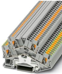
Mehrstockklemme, Nennspannung: 500 V, Nennstrom: 24 A, Anschlussart: Push-in-Anschluss, 1. und 2. Etage, Bemessungsquerschnitt: 2,5 mm<sup>2</sup>, Querschnitt: 0,14 mm<sup>2</sup> - 4 mm<sup>2</sup>, Montageart: NS 35/7,5, NS 35/15, Farbe: grau
