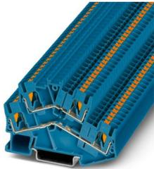
Doppelstockklemme, Nennspannung: 500 V, Nennstrom: 22 A, Anschlussart: Push-in-Anschluss, 1. und 2. Etage, Bemessungsquerschnitt: 2,5 mm<sup>2</sup>, Querschnitt: 0,14 mm<sup>2</sup> - 4 mm<sup>2</sup>, Montageart: NS 35/7,5, NS 35/15, Farbe: blau
