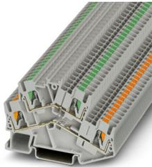
Doppelstockklemme, mit Pusher unten orange und oben grün, Querschnitt:  $0,14 \text{ mm}^2 - 4 \text{ mm}^2$ , AWG: 26 - 12, Anschlussart: Push-in-Anschluss, Breite: 5,2 mm, Farbe: grau, Montageart: NS 35/7,5, NS 35/15
