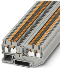
Durchgangsklemme, mit unterbrochenem Strombalken, Nennspannung: 500 V, Nennstrom: 20 A, Anzahl der Anschlüsse: 4, Anschlussart: Push-in-Anschluss, Bemessungsquerschnitt: 2,5 mm<sup>2</sup>, Querschnitt: 0,14 mm<sup>2</sup> - 4 mm<sup>2</sup>, Montageart: NS 35/7,5, NS 35/15, Farbe: grau
