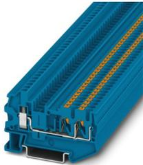
Durchgangsklemme, Nennspannung: 800 V, Nennstrom: 24 A, Anschlussart: Push-in-Anschluss, Bemessungsquerschnitt: 2,5 mm<sup>2</sup>, Querschnitt: 0,14 mm<sup>2</sup> - 4 mm<sup>2</sup>, Anschlussart: Schraubanschluss, Bemessungsquerschnitt: 2,5 mm<sup>2</sup>, Querschnitt: 0,14 mm<sup>2</sup> - 4 mm<sup>2</sup>, Montage: NS 35/7,5, NS 35/15, Farbe: blau
