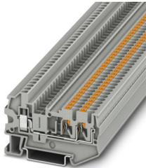
Durchgangsklemme, Nennspannung: 800 V, Nennstrom: 24 A, Anschlussart: Push-in-Anschluss, Bemessungsquerschnitt: 2,5 mm<sup>2</sup>, Querschnitt: 0,14 mm<sup>2</sup> - 4 mm<sup>2</sup>, Anschlussart: Schraubanschluss, Bemessungsquerschnitt: 2,5 mm<sup>2</sup>, Querschnitt: 0,14 mm<sup>2</sup> - 4 mm<sup>2</sup>, Montage: NS 35/7,5, NS 35/15, Farbe: grau
