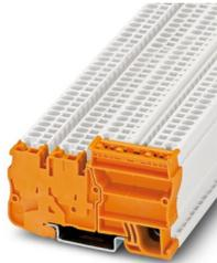
Einspeiseklemme, Nennspannung: 250 V, Nennstrom: 30 A, Anzahl der Anschlüsse: 4, Anschlussart: Zugfederanschluss, Bemessungsquerschnitt: 2,5 mm<sup>2</sup>, Querschnitt: 0,08 mm<sup>2</sup> - 4 mm<sup>2</sup>, Montageart: NS 35/7,5, NS 35/15, Farbe: orange
