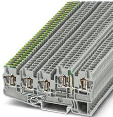
Installations-Schutzleiterklemme, Nennspannung: 24 V, Nennstrom: 18 A, Anzahl der Anschlüsse: 5, Anschlussart: Zugfederanschluss, Bemessungsquerschnitt: 2,5 mm<sup>2</sup>, Querschnitt: 0,08 mm<sup>2</sup> - 4 mm<sup>2</sup>, Montageart: NS 35/7,5, NS 35/15, Farbe: grau
