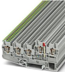
Installations-Schutzleiterklemme, Nennspannung: 24 V, Nennstrom: 18 A, Anzahl der Anschlüsse: 5, Anschlussart: Zugfederanschluss, Bemessungsquerschnitt: 2,5 mm<sup>2</sup>, Querschnitt: 0,08 mm<sup>2</sup> - 4 mm<sup>2</sup>, Montageart: NS 35/7,5, NS 35/15, Farbe: grau
