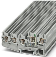
Initiatoren-/Aktorenklemme, Nennspannung: 24 V, Nennstrom: 18 A, Anzahl der Anschlüsse: 5, Anschlussart: Zugfederanschluss, Bemessungsquerschnitt: 2,5 mm<sup>2</sup>, Querschnitt: 0,08 mm<sup>2</sup> - 4 mm<sup>2</sup>, Montageart: NS 35/7,5, NS 35/15, Farbe: grau
