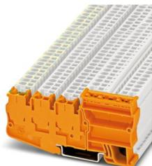
Installations-Schutzleiterklemme, Nennspannung: 250 V, Nennstrom: 30 A, Anzahl der Anschlüsse: 5, Anschlussart: Zugfederanschluss, Bemessungsquerschnitt: 2,5 mm<sup>2</sup>, Querschnitt: 0,08 mm<sup>2</sup> - 4 mm<sup>2</sup>, Montageart: NS 35/7,5, NS 35/15, Farbe: orange
