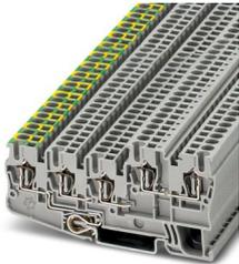
Installations-Schutzleiterklemme, Nennspannung: 250 V, Nennstrom: 18 A, Anzahl der Anschlüsse: 5, Anschlussart: Zugfederanschluss, Bemessungsquerschnitt: 2,5 mm<sup>2</sup>, Querschnitt: 0,08 mm<sup>2</sup> - 4 mm<sup>2</sup>, Montageart: NS 35/7,5, NS 35/15, Farbe: grau
