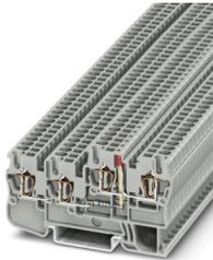
Initiatoren-/Aktorenklemme, Nennspannung: 24 V, Nennstrom: 18 A, Anzahl der Anschlüsse: 4, Anschlussart: Zugfederanschluss, Bemessungsquerschnitt: 2,5 mm<sup>2</sup>, Querschnitt: 0,08 mm<sup>2</sup> - 4 mm<sup>2</sup>, Montageart: NS 35/7,5, NS 35/15, Farbe: grau
