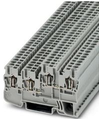
Initiatoren-/Aktorenklemme, Nennspannung: 250 V, Nennstrom: 18 A, Anzahl der Anschlüsse: 4, Anschlussart: Zugfederanschluss, Bemessungsquerschnitt: 2,5 mm<sup>2</sup>, Querschnitt: 0,08 mm<sup>2</sup> - 4 mm<sup>2</sup>, Montageart: NS 35/7,5, NS 35/15, Farbe: grau
