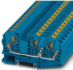
Durchgangsklemme, Nennspannung: 1000 V, Nennstrom: 76 A, Anzahl der Anschlüsse: 3, Anschlussart: Push-in-Anschluss, Bemessungsquerschnitt: 16 mm<sup>2</sup>, Querschnitt: 0,5 mm<sup>2</sup> - 25 mm<sup>2</sup>, Montageart: NS 35/7,5, NS 35/15, Farbe: blau
