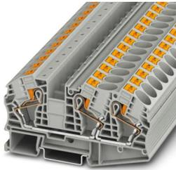
Durchgangsklemme, Nennspannung: 1000 V, Nennstrom: 76 A, Anzahl der Anschlüsse: 3, Anschlussart: Push-in-Anschluss, Bemessungsquerschnitt: 16 mm<sup>2</sup>, Querschnitt: 0,5 mm<sup>2</sup> - 25 mm<sup>2</sup>, Montageart: NS 35/7,5, NS 35/15, Farbe: grau
