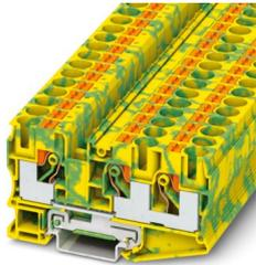
Schutzleiter-Reihenklemme, Anzahl der Anschlüsse: 3, Anschlussart: Push-in-Anschluss, Bemessungsquerschnitt: 10 mm<sup>2</sup>, Querschnitt: 0,5 mm<sup>2</sup> - 16 mm<sup>2</sup>, Montageart: NS 35/7,5, NS 35/15, Farbe: grün-gelb
