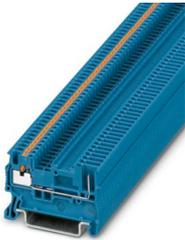
Durchgangsklemme, Nennspannung: 500 V, Nennstrom: 17,5 A, Anzahl der Anschlüsse: 2, Anschlussart: Push-in- / Steckanschluss, Bemessungsquerschnitt: 1,5 mm<sup>2</sup>, 1. Etage, Querschnitt: 0,14 mm<sup>2</sup> - 1,5 mm<sup>2</sup>, Montageart: NS 35/7,5, NS 35/15, Farbe: blau
