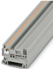
Durchgangsklemme, Nennspannung: 500 V, Nennstrom: 17,5 A, Anzahl der Anschlüsse: 2, Anschlussart: Push-in- / Steckanschluss, Bemessungsquerschnitt: 1,5 mm<sup>2</sup>, 1. Etage, Querschnitt: 0,14 mm<sup>2</sup> - 1,5 mm<sup>2</sup>, Montageart: NS 35/7,5, NS 35/15, Farbe: grau
