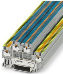
Schutzleiter-Doppelstockklemme, Nennspannung: 500 V, Nennstrom: 16 A, Anschlussart: Push-in-Anschluss, 1. und 2. Etage, Bemessungsquerschnitt: 1,5 mm<sup>2</sup>, Querschnitt: 0,14 mm<sup>2</sup> - 1,5 mm<sup>2</sup>, Montageart: NS 35/7,5, NS 35/15, Farbe: grau
