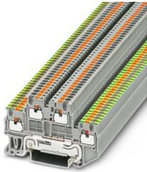
Mehrstockklemme, Nennspannung: 500 V, Nennstrom: 16 A, Anschlussart: Push-in-Anschluss, 1. und 2. Etage, Bemessungsquerschnitt: 1,5 mm<sup>2</sup>, Querschnitt: 0,14 mm<sup>2</sup> - 1,5 mm<sup>2</sup>, Montageart: NS 35/7,5, NS 35/15, Farbe: grau
