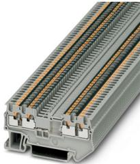
Durchgangsklemme, Nennspannung: 500 V, Nennstrom: 15 A, Anzahl der Anschlüsse: 4, Anschlussart: Push-in-Anschluss, Bemessungsquerschnitt: 1,5 mm<sup>2</sup>, 1. Etage, Querschnitt: 0,14 mm<sup>2</sup> - 1,5 mm<sup>2</sup>, Montageart: NS 35/7,5, NS 35/15, Farbe: grau
