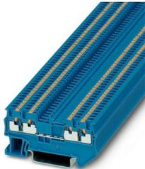
Durchgangsklemme, Nennspannung: 500 V, Nennstrom: 17,5 A, Anzahl der Anschlüsse: 4, Anschlussart: Push-in-Anschluss, Bemessungsquerschnitt: 1,5 mm<sup>2</sup>, 1. Etage, Querschnitt: 0,14 mm<sup>2</sup> - 1,5 mm<sup>2</sup>, Montageart: NS 35/7,5, NS 35/15, Farbe: blau
