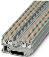
Durchgangsklemme, Nennspannung: 500 V, Nennstrom: 17,5 A, Anzahl der Anschlüsse: 4, Anschlussart: Push-in-Anschluss, Bemessungsquerschnitt: 1,5 mm<sup>2</sup>, Querschnitt: 0,14 mm<sup>2</sup> - 1,5 mm<sup>2</sup>, Montageart: NS 35/7,5, NS 35/15, Farbe: grau
