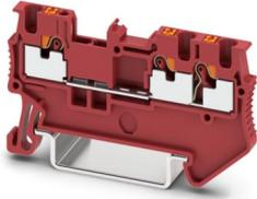
Durchgangsklemme, Nennspannung: 500 V, Nennstrom: 17,5 A, Anzahl der Anschlüsse: 3, Anschlussart: Push-in-Anschluss, Bemessungsquerschnitt: 1,5 mm<sup>2</sup>, 1. Etage, Querschnitt: 0,14 mm<sup>2</sup> - 1,5 mm<sup>2</sup>, Montageart: NS 35/7,5, NS 35/15, Farbe: rot
