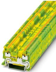
Schutzleiter-Reihenklemme, Anzahl der Anschlüsse: 2, Anschlussart: Push-in-Anschluss, 1. Etage, Querschnitt: 0,14 mm<sup>2</sup> - 1,5 mm<sup>2</sup>, Montageart: NS 35/7,5, NS 35/15, Farbe: grün-gelb
