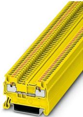
Durchgangsklemme, Nennspannung: 500 V, Nennstrom: 17,5 A, Anzahl der Anschlüsse: 2, Anschlussart: Push-in-Anschluss, Bemessungsquerschnitt: 1,5 mm<sup>2</sup>, 1. Etage, Querschnitt: 0,14 mm<sup>2</sup> - 1,5 mm<sup>2</sup>, Montageart: NS 35/7,5, NS 35/15, Farbe: gelb
