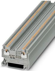
Durchgangsklemme, Nennspannung: 500 V, Nennstrom: 17,5 A, Anzahl der Anschlüsse: 2, Anschlussart: Push-in-Anschluss, Bemessungsquerschnitt: 1,5 mm<sup>2</sup>, 1. Etage, Querschnitt: 0,14 mm<sup>2</sup> - 1,5 mm<sup>2</sup>, Montageart: NS 35/7,5, NS 35/15, Farbe: grau
