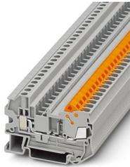
Durchgangsklemme, Nennspannung: 800 V, Nennstrom: 24 A, Anschlussart: Schnellanschluss, Bemessungsquerschnitt: 2,5 mm<sup>2</sup>, Querschnitt: 0,5 mm<sup>2</sup> - 2,5 mm<sup>2</sup>, Anschlussart: Schraubanschluss, Bemessungsquerschnitt: 2,5 mm<sup>2</sup>, Querschnitt: 0,14 mm<sup>2</sup> - 6 mm<sup>2</sup>, Montage: NS 35/7,5, NS 35/15, Farbe: grau
