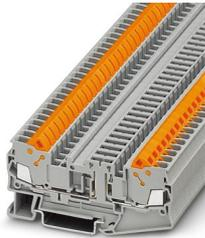
Trennklemme, Strom und Spannung werden durch den eingesetzten Stecker bestimmt., Nennspannung: 500 V, Nennstrom: 20 A, 1. Etage, Anschlussart: Schnellanschluss, Bemessungsquerschnitt: 2,5 mm<sup>2</sup>, Querschnitt: 0,5 mm<sup>2</sup> - 2,5 mm<sup>2</sup>, Montage: NS 35/7,5, NS 35/15, Farbe: grau
