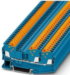
Durchgangsklemme, Nennspannung: 800 V, Nennstrom: 24 A, Anzahl der Anschlüsse: 3, Anschlussart: Schnellanschluss, Bemessungsquerschnitt: 2,5 mm<sup>2</sup>, 1. Etage, Querschnitt: 0,5 mm<sup>2</sup> - 2,5 mm<sup>2</sup>, Montageart: NS 35/7,5, NS 35/7,5, Farbe: blau
