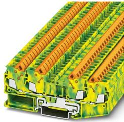
Schutzleiter-Reihenklemme, Anzahl der Anschlüsse: 4, Anschlussart: Schnellanschluss, Querschnitt: 0,5 mm<sup>2</sup> - 2,5 mm<sup>2</sup>, Montageart: NS 35/7,5, NS 35/7,5, Farbe: grün-gelb
