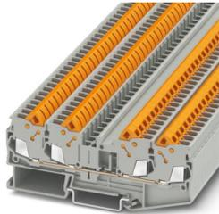
Durchgangsklemme, Nennspannung: 800 V, Nennstrom: 24 A, Anzahl der Anschlüsse: 4, Anschlussart: Schnellanschluss, Bemessungsquerschnitt: 2,5 mm<sup>2</sup>, 1. Etage, Querschnitt: 0,5 mm<sup>2</sup> - 2,5 mm<sup>2</sup>, Montageart: NS 35/7,5, NS 35/7,5, Farbe: grau
