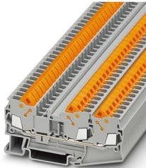
Durchgangsklemme, Nennspannung: 800 V, Nennstrom: 24 A, Anzahl der Anschlüsse: 3, Anschlussart: Schnellanschluss, Bemessungsquerschnitt: 2,5 mm<sup>2</sup>, 1. Etage, Querschnitt: 0,5 mm<sup>2</sup> - 2,5 mm<sup>2</sup>, Montageart: NS 35/7,5, NS 35/7,5, Farbe: grau
