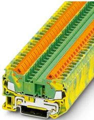
Schutzleiter-Reihenklemme, Anzahl der Anschlüsse: 2, Polzahl: 1, Anschlussart: Schnellanschluss, 1. Etage, Querschnitt: 0,5 mm<sup>2</sup> - 2,5 mm<sup>2</sup>, Montageart: NS 35/7,5, NS 35/15, Farbe: grün-gelb
