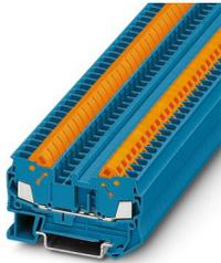
Durchgangsklemme, Nennspannung: 800 V, Nennstrom: 24 A, Anzahl der Anschlüsse: 2, Anschlussart: Schnellanschluss, Bemessungsquerschnitt: 2,5 mm<sup>2</sup>, 1. Etage, Querschnitt: 0,5 mm<sup>2</sup> - 2,5 mm<sup>2</sup>, Montageart: NS 35/7,5, NS 35/15, Farbe: blau
