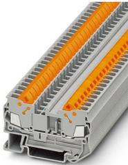
Durchgangsklemme, Nennspannung: 800 V, Nennstrom: 24 A, Anzahl der Anschlüsse: 2, Anschlussart: Schnellanschluss, Bemessungsquerschnitt: 2,5 mm<sup>2</sup>, 1. Etage, Querschnitt: 0,5 mm<sup>2</sup> - 2,5 mm<sup>2</sup>, Montageart: NS 35/7,5, NS 35/15, Farbe: grau
