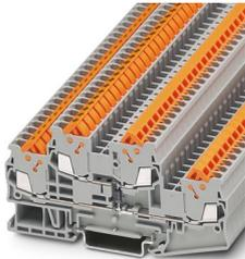
Bauelementreihenklemme, Der max. Strom wird durch die Diode bestimmt. Eingebaut: Diode 1N 4007, Sperrspannung: 1300 V, Dauergrenzstrom: 0,5 A., mit integrierter Diode, Nennstrom: 0,5 A, Anschlussart: Schnellanschluss, 1. und 2. Etage, Bemessungsquerschnitt: 1,5 mm<sup>2</sup>, Querschnitt: 0,25 mm<sup>2</sup> - 1,5 mm<sup>2</sup>, Montageart: NS 35/7,5, NS 35/15, Farbe: grau
