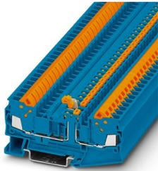
Messertrennklemme, Nennspannung: 500 V, Nennstrom: 20 A, 1. Etage, Anschlussart: Schnellanschluss, Bemessungsquerschnitt: 2,5 mm<sup>2</sup>, Querschnitt: 0,5 mm<sup>2</sup> - 2,5 mm<sup>2</sup>, Montage: NS 35/7,5, NS 35/7,5, Farbe: blau
