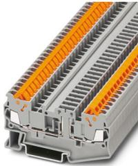
Trennklemme, Strom und Spannung werden durch den eingesetzten Stecker bestimmt., Nennspannung: 400 V, Nennstrom: 17,5 A, 1. Etage, Anschlussart: Schnellanschluss, Bemessungsquerschnitt: 1,5 mm<sup>2</sup>, Querschnitt: 0,25 mm<sup>2</sup> - 1,5 mm<sup>2</sup>, Montage: NS 35/7,5, NS 35/15, Farbe: grau
