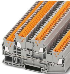
Doppelstockklemme, Nennspannung: 500 V, Nennstrom: 17,5 A, Anschlussart: Schnellanschluss, 1. und 2. Etage, Bemessungsquerschnitt: 1,5 mm<sup>2</sup>, Querschnitt: 0,25 mm<sup>2</sup> - 1,5 mm<sup>2</sup>, Montageart: NS 35/7,5, NS 35/15, Farbe: grau
