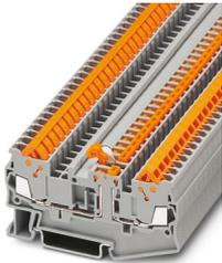
Messertrennklemme, Nennspannung: 400 V, Nennstrom: 17,5 A, 1. Etage, Anschlussart: Schnellanschluss, Bemessungsquerschnitt: 1,5 mm<sup>2</sup>, Querschnitt: 0,25 mm<sup>2</sup> - 1,5 mm<sup>2</sup>, Montage: NS 35/7,5, NS 35/15, Farbe: grau
