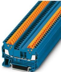
Durchgangsklemme, Nennspannung: 800 V, Nennstrom: 17,5 A, Anzahl der Anschlüsse: 2, Anschlussart: Schnellanschluss, Bemessungsquerschnitt: 1,5 mm<sup>2</sup>, 1. Etage, Querschnitt: 0,25 mm<sup>2</sup> - 1,5 mm<sup>2</sup>, Montageart: NS 35/7,5, NS 35/15, Farbe: blau
