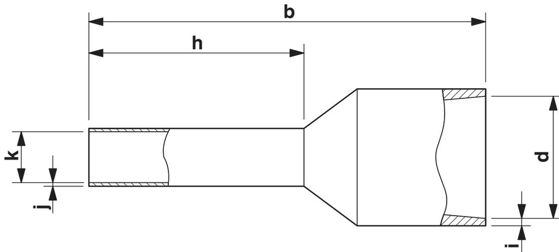
Hüslenlänge (b), Länge Kontaktbereich (h), Innenmaß Isolierkragen (d), Hüsendurchmesser (k), Isolierkragenstärke (i), Hüslenwandstärke (j)
