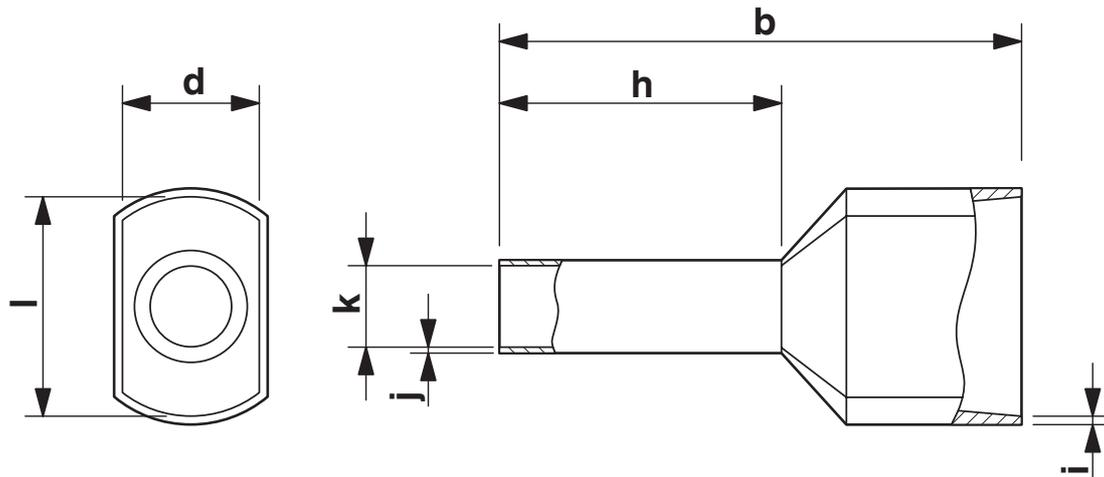
Hülsenlänge (b), Länge Kontaktbereich (h), Innenmaß Isolierkragen (d), Hüsendurchmesser (k), Isolierkragenstärke (i), Hülsenwandstärke (j)
