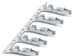
Modul-Buchsenkontakt, wird nach dem Ankrimpen des Leiters in das PCC- oder HCC-Steckergehäuse geschoben, für Leiter von 1,5 mm<sup>2</sup> ... 2,5 mm<sup>2</sup>, Bandkontakt
