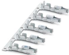
Modul-Buchsenkontakt, wird nach dem Ancrimpen des Leiters in das PCC oder HCC Steckergehäuse geschoben, für Leiter von 0,5 mm<sup>2</sup> ... 1,0 mm<sup>2</sup>, Bandkontakt
