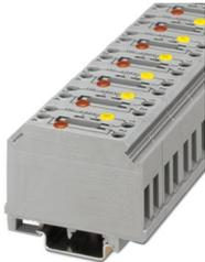
Trennklemme, Nennspannung: 250 V, Nennstrom: 41 A, 1. Etage, Anschlussart: Schraubanschluss, Bemessungsquerschnitt: 6 mm<sup>2</sup>, Querschnitt: 0,5 mm<sup>2</sup> - 10 mm<sup>2</sup>, Montage: NS 35/7,5, NS 35/15, NS 32, Farbe: grau
