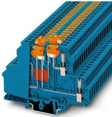
Messertrennklemme, mit Prüfbuchschrauben zur Aufnahme von Prüfsteckern, Nennspannung: 400 V, Nennstrom: 10 A, 1. und 2. Etage, Anschlussart: Schraubanschluss, Bemessungsquerschnitt: 4 mm<sup>2</sup>, Querschnitt: 0,2 mm<sup>2</sup> - 4 mm<sup>2</sup>, 2. Etage, Anschlussart: Schraubanschluss, Bemessungsquerschnitt: 4 mm<sup>2</sup>, Querschnitt: 0,2 mm<sup>2</sup> - 4 mm<sup>2</sup>, Montage: NS 35/7,5, NS 35/15, NS 32, Farbe: blau
